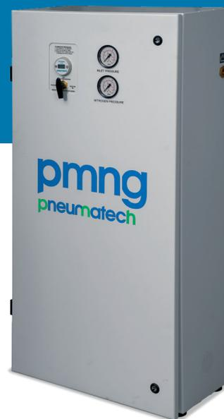
Sfruttando delle speciali membrane semi-permeabili, questi piccoli generatori riescono a separare azoto ed ossigeno fino a purezze del 99,5%. Facendo fluire l'aria compressa all'interno dei filamenti che costituiscono la membrana, le molecole di ossigeno, più piccole e mobili, riescono a uscire attraverso la superficie dei filamenti, mentre l'azoto resta confinato all'interno, concentrandosi all'uscita della membrana stessa.
