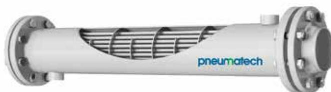
L'air comprimé sera toujours 100 % saturé d'eau lorsqu'il sort du compresseur. Cependant, la température de sortie a également une influence importante sur la quantité d'eau en aval du compresseur. Afin de réduire la taille du sécheur frigorifique ou par adsorption en aval, il est par conséquent recommandé d'installer un refroidisseur final hautement efficace entre le compresseur et le sécheur.
