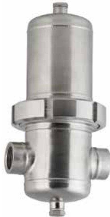
In Prozessindustrien, wo die Gefahr von Korrosion an den Komponenten der Druckluftanlage hoch ist, sorgt die Reihe der FP 1–18-Prozessfilter von Pneumatech für die richtige Lösung. Das Filtergehäuse besteht aus der Edelmetalle 1.4301. Die Oberfläche wird in modernen mechanischen und elektronischen Verfahren auf Ra 1,6 Ebenheit poliert. Damit sich zwischen Filterkopf und Schale keine Mikroorganismen
